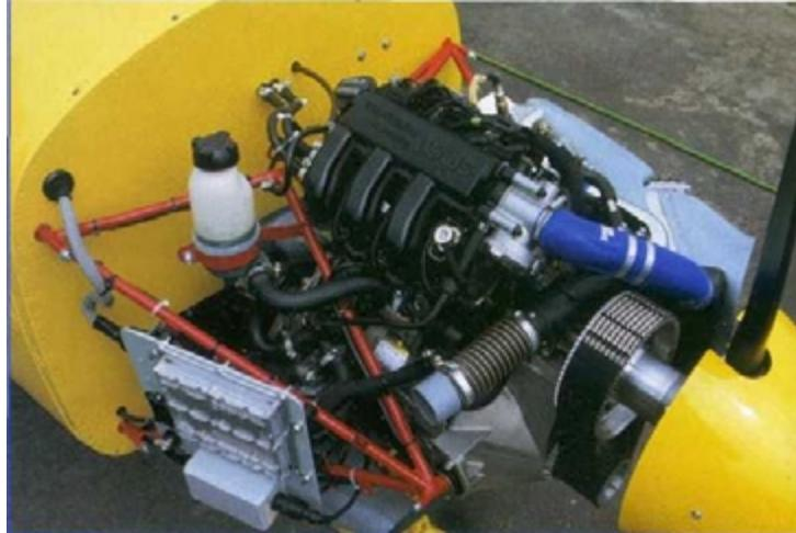
**HIGH-TECH IM UL:** Der M160/1 holt aus 698 cm<sup>3</sup> Hubraum dank Abgasturbolader 60 kW (82 PS).
