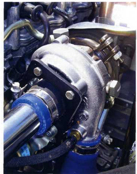
Links: Durch die Ecofly-Zahnriemenuntersetzung dreht der Prop »Cruise« mit maximal 2760 Touren. Rechts: Der neue Turbolader mit erhöhtem Ladedruck bringt einen Leistungszuwachs von 19 PS
